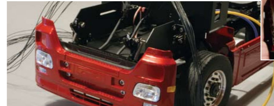
Die Stoßstange mit den verkabelten Scheinwerfern ist wieder montiert und die Leitungen bereits zum späteren Montageort der Lichtanlage durchgezogen
