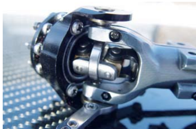
Doppel-Kardangeln heben die Drehzahlverschiebung durch gegenseitige Anordnung der Gelenkbauteile wieder auf
