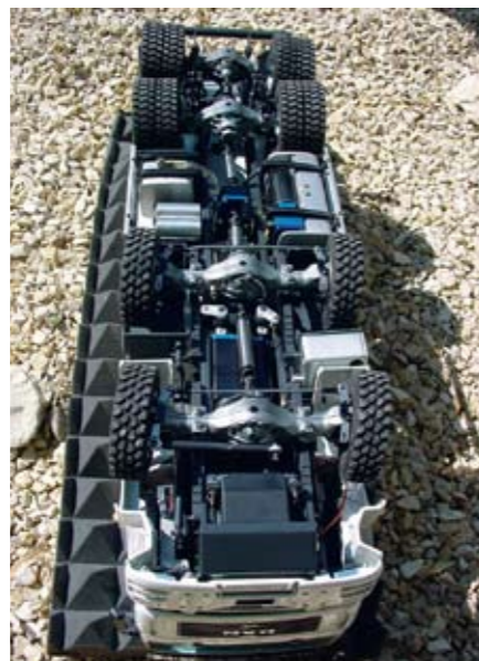
Geländegängiges Vierachs-fahrgestell mit Allradantrieb
