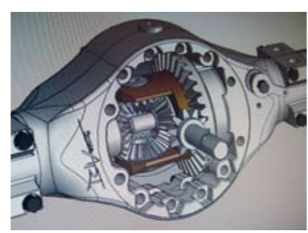
So sieht ein Kegeldifferential von innen aus
