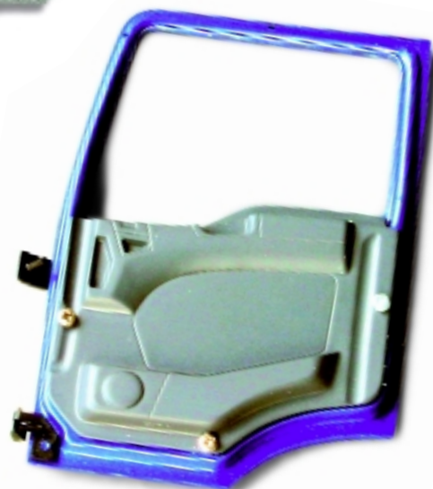
Die Türinnenverkleidung wird mit drei Schrauben befestigt, was optisch eher Geschmacksache ist; die Schlitzschraube ist magnetisch und besorgt mit einem kleinen Magneten als Gegenpart das Zuhalten der Türen
