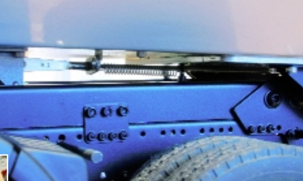
Der Verschlussmechanismus für die Heckklappe; links erkennt man den Umlenkhebel, der bei Kontakt mit dem Rahmen die Heckklappe zuzieht
