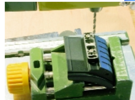
Die hinteren Kotflügel müssen zur LED-Montage durchbohrt werden
