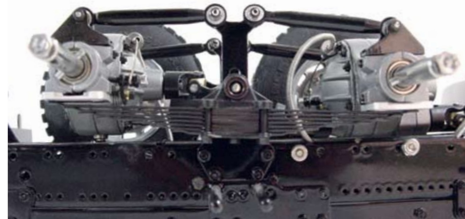
Mit einer Pendelachse kann man effektiv gewährleisten, dass alle Räder stets Bodenkontakt haben
